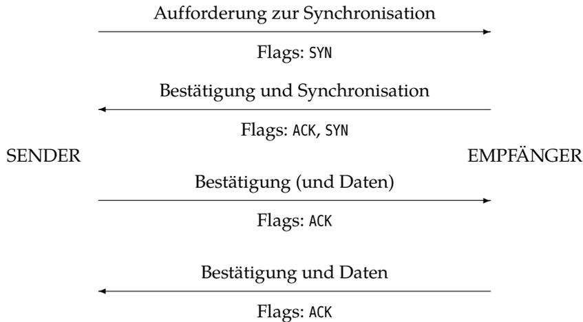
**Bild 3.6:** Aufbau einer TCP-Verbindung: Der Drei-Wege-Handshake
