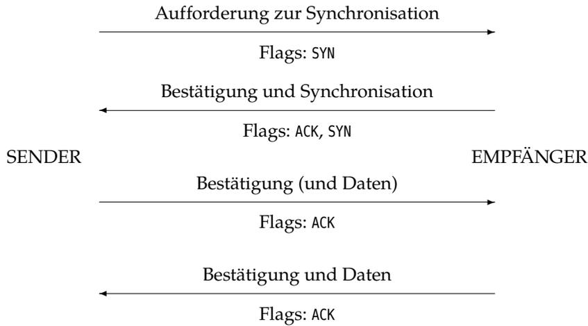
**Bild 22.6:** Aufbau einer TCP-Verbindung: Der Drei-Wege-Handshake
